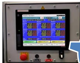
Touchscreen-Bedienterminals zur Einstellung und Vorgabe der Bad- sowie der Prozessparameter, Prozessablauf und Prozessprogrammierung.
